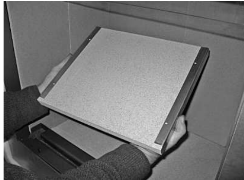
Onderste vlamkeerplaat. Verwijderen door deze op te lichten, naar voren te kantelen en uit te nemen.
